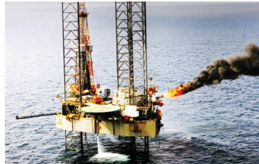
Giàn khoan với ngọn lửa của dòng dầu khí trong quá trình thử vi-
