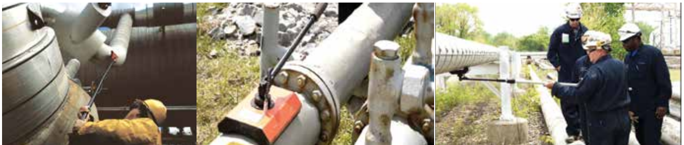
Hình 6. Thiết bị đo tán xạ ngược neutron phát hiện độ ẩm dưới lớp bảo ôn [2]
