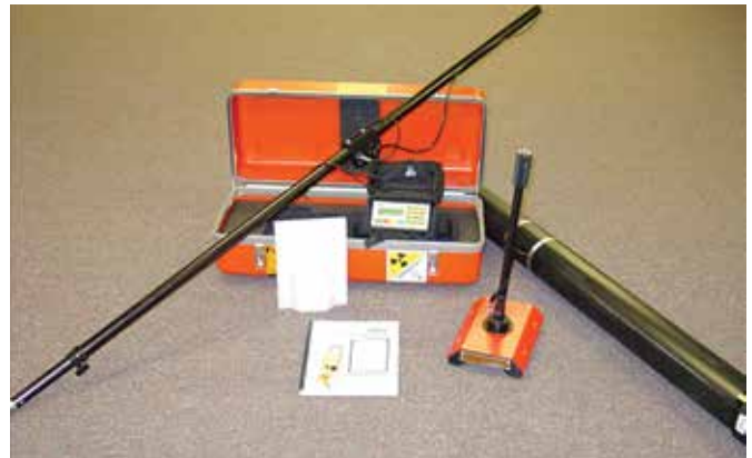
Hình 5. Cấu tạo và hình ảnh thiết bị đo tán xạ ngược neutron [2]
