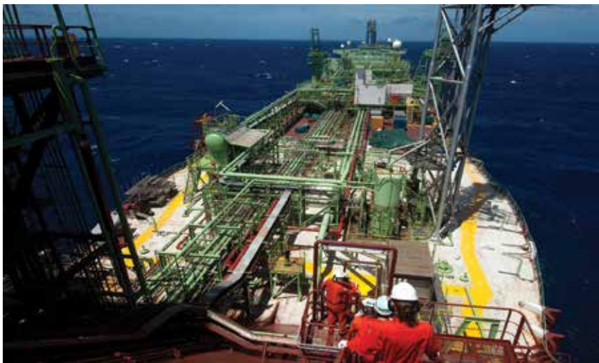
FPSO P-76 có công suất xử lý tới 150.000 thùng dầu và nén tới 6 triệu m 3 khí tự nhiên mỗi ngày. Nguồn: Petrobras
